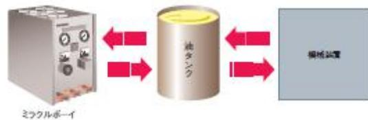
「ミラクルボーイ」は独自の多機能フィルターにより油の劣化原因となる汚染物を除去し常に新油状態に保つ事が最大の特徴である。従来は油の劣化とともに新油に交換するのが常識とされていたが「ミラクルボーイ」の導入により10年以上オイル交換
